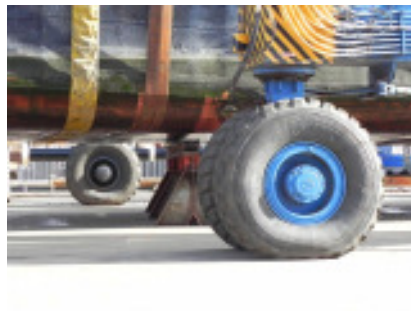
Die 110 Tonnen der RIA drücken schon ein wenig auf die Reifen.
