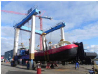
Die Bernardus hängt am 140 Tonnen Kran.
