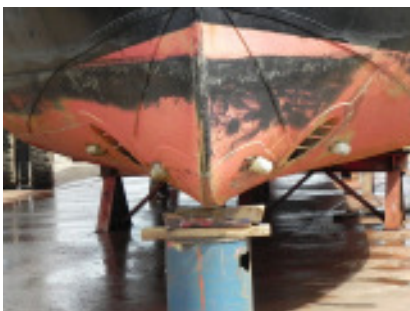
Passt! Das ist wichtig, sonst kann das Schiff Schaden nehmen. Es sind immerhin 110 Tonnen, die hier drücken. Da muss es genau stimmen.
