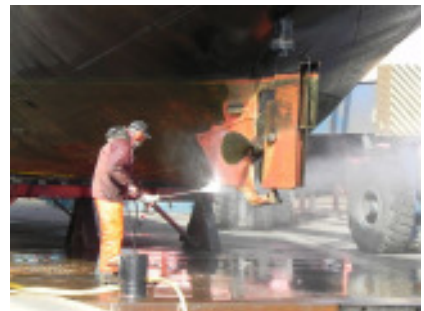
Roy dampft das Unterwasser der RIA mit dem speziell Hochdruckreiniger ab.
