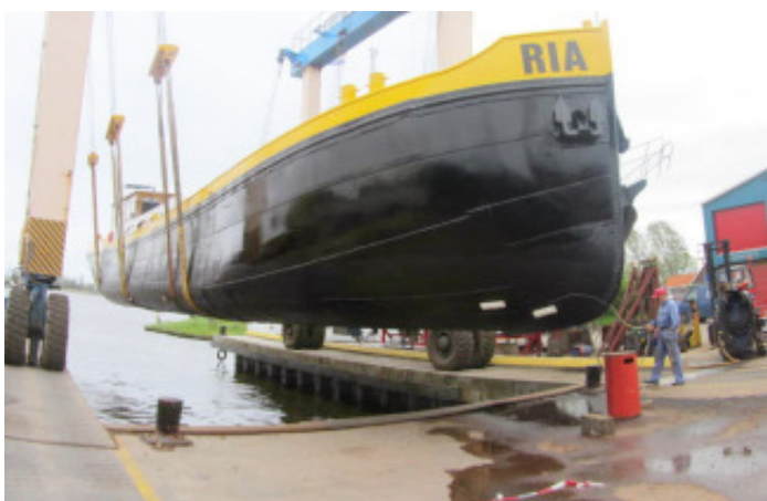
Die RIA wird wieder eingewassert.
